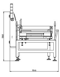
**适用范围** ▶ 本产品主要适用于大重量、大体积物品的重量检测,尤其适用于整箱内物品缺件检测; 如: 缺瓶、缺盒、缺个、 缺袋、缺罐等
